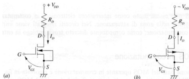
Fig. 6 (a) Circuito base dell'NMOS e (b) del PMOS in funzionamento ON-OFF.
